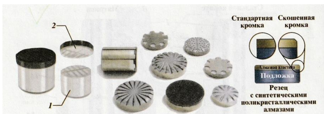
Сурет 2.13 – Үшбұрышты қашаулардың конструкциясы және бекітілу пішіндері
